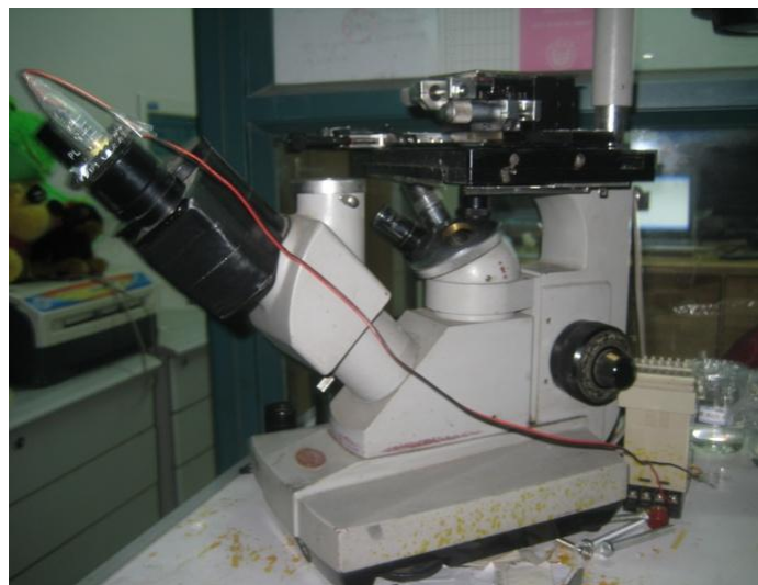
图 4.2 自制激光光源的显微镜平台
